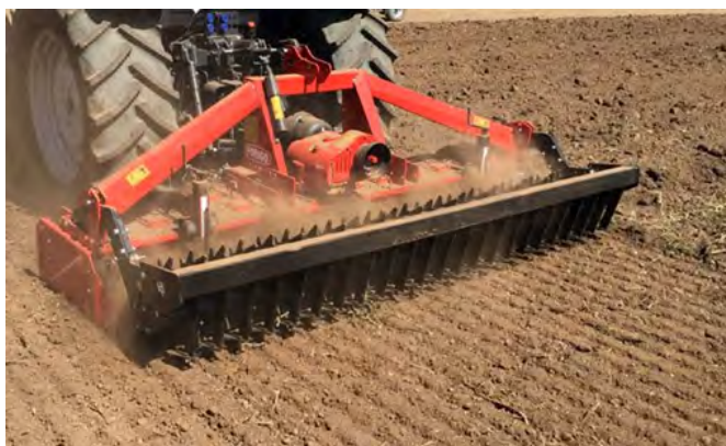
Erpice montato su trattore agricolo per lo scotico
