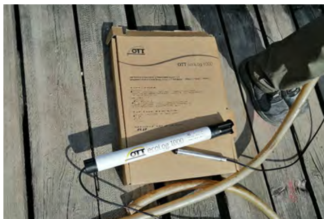
Sensore per il monitoraggio dei livelli dell'acqua
