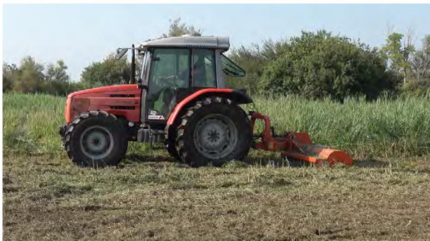
Eliminazione della vegetazione con trattore agricola montante una trinciatrice di tipo leggero
