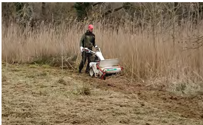
Lavorazione superficiale con trincia a conduzione manuale
