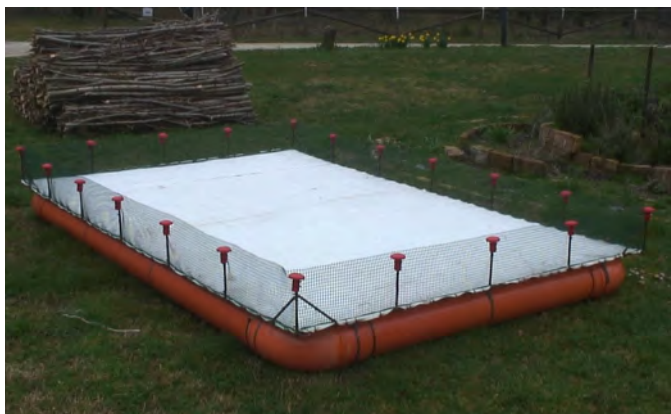
Zattera completata con il geotessuto di appoggio e le protezioni esterne.
