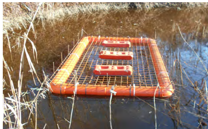
Prova di galleggiabilità di una zattera
