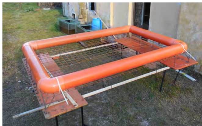
Montaggio dell'intelaiatura dei tubi in pvc sulla rete elettrosaldata.
