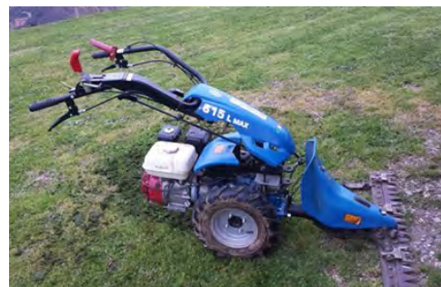
Barra falciante montata su motocoltivatore manuale
