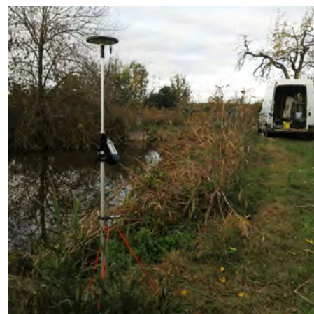
Rilievo batimetrico con gps differenziale
