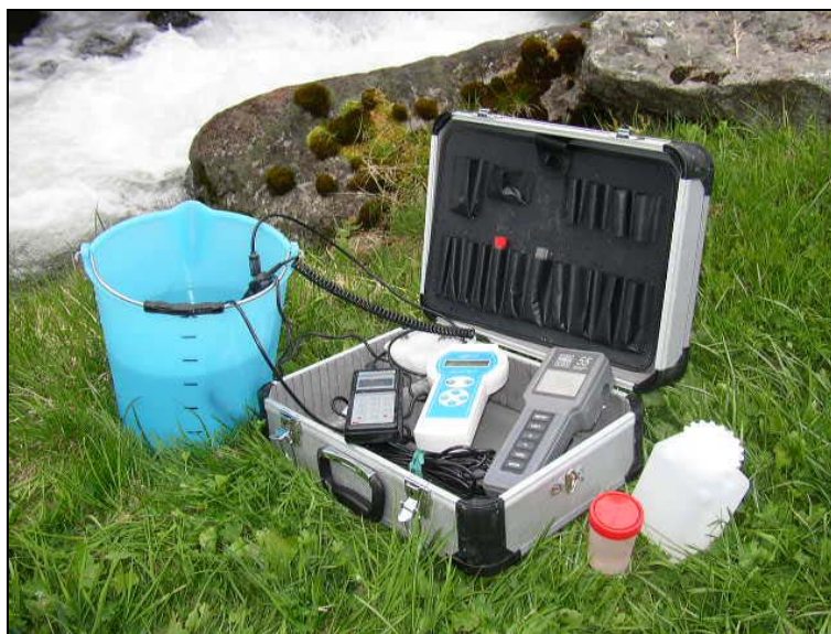
Foto 2 - Set di strumenti portatili utilizzati per la misurazione dei parametri-chimico fisici delle acque
